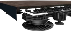
Befestigung der Blende mit Edelstahlschrauben 4,8x38 (Ref. 1518), Vorbohrung Durchmesser 5 mm.
